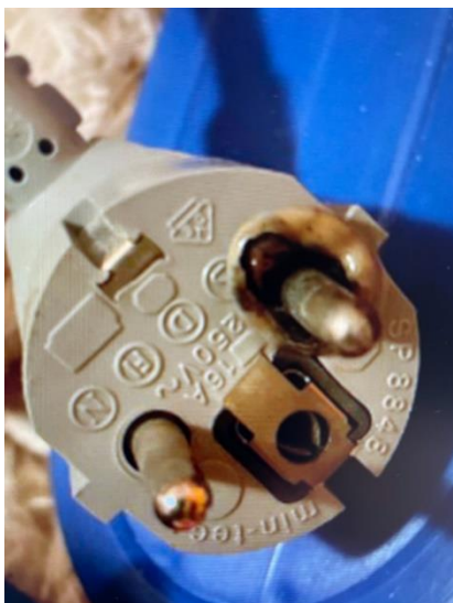
Plugg og stikkontakt til varmtvassberedar med tydelege teikn til varmgang. Avdekket på kontroll av DLE
